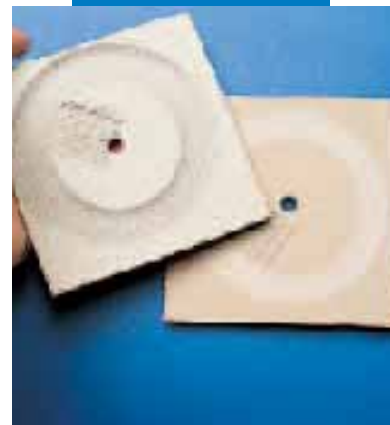
Abrasion TABER sur Ultraplan (à droite) comparativement à un ragréage conventionnel (à gauche)
